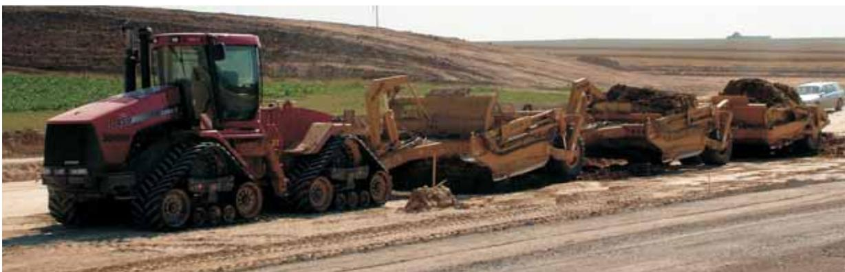
Steiger Quadtrac (mit Kettenfahrwerk) STX 450 mit 3 Anhängeschürfkübel Reynolds
