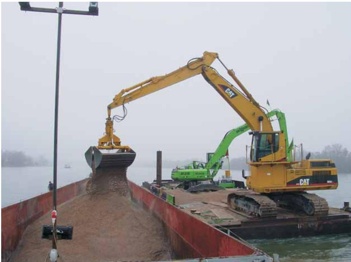
Schwerlastponton "S6" mit 2 Baggern (Sennebogen 835 und Caterpillar 365 B L) bei der Beladung des Schubleichters "Otto" (1800 Tonnen Nutzlast).
