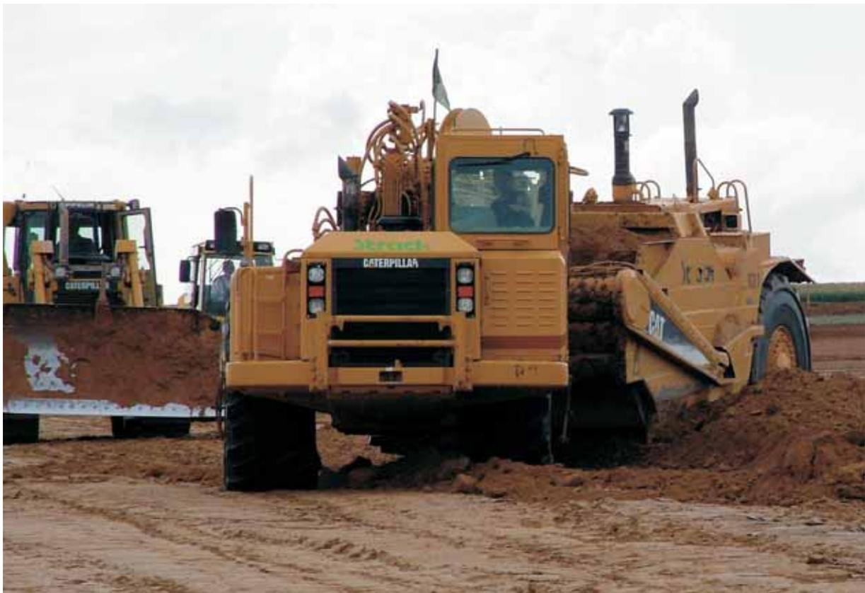
Motorschürfwagen (Doppelmotor-Scraper) Caterpillar 627 G mit einem Gesamtgewicht von ca. 70 Tonnen
