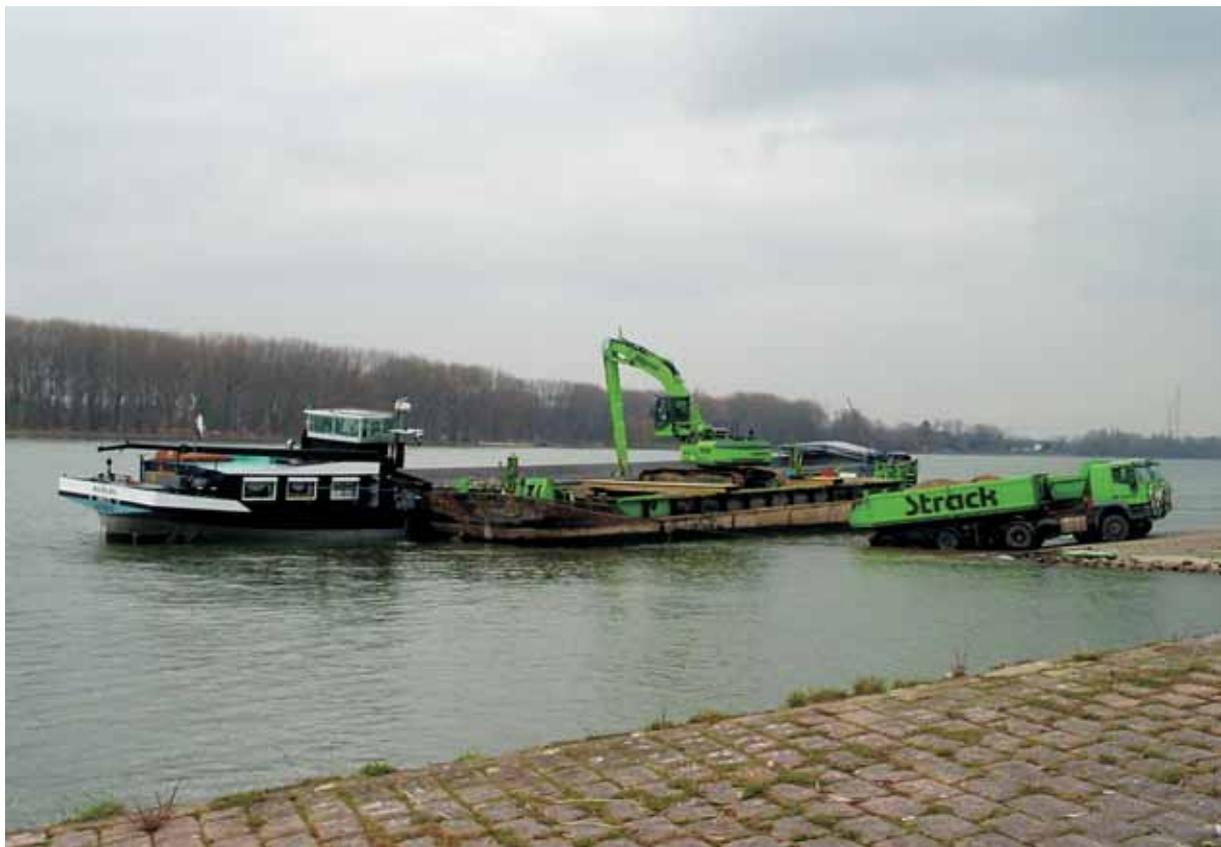
Löschen der MS "Manana" mit dem Umschlagbagger Sennebogen 835 (auf Ponton "S11" stehend) in Sattelzüge an der Nato-Rampe in Mainz-Weisenau
